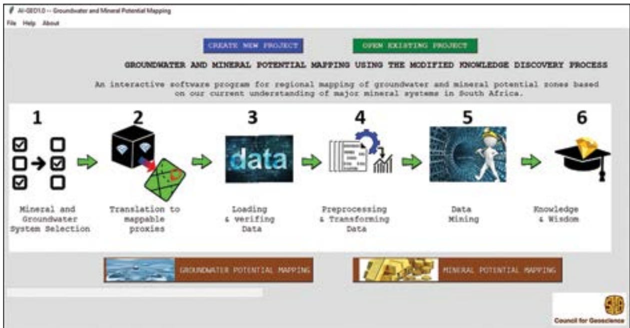
Seswantšho sa 24: Tshepedišo ye e fetotšwego ya kutollo ya tsebo ye e šomišwago ke softewere ya AI_GEO 1.0
